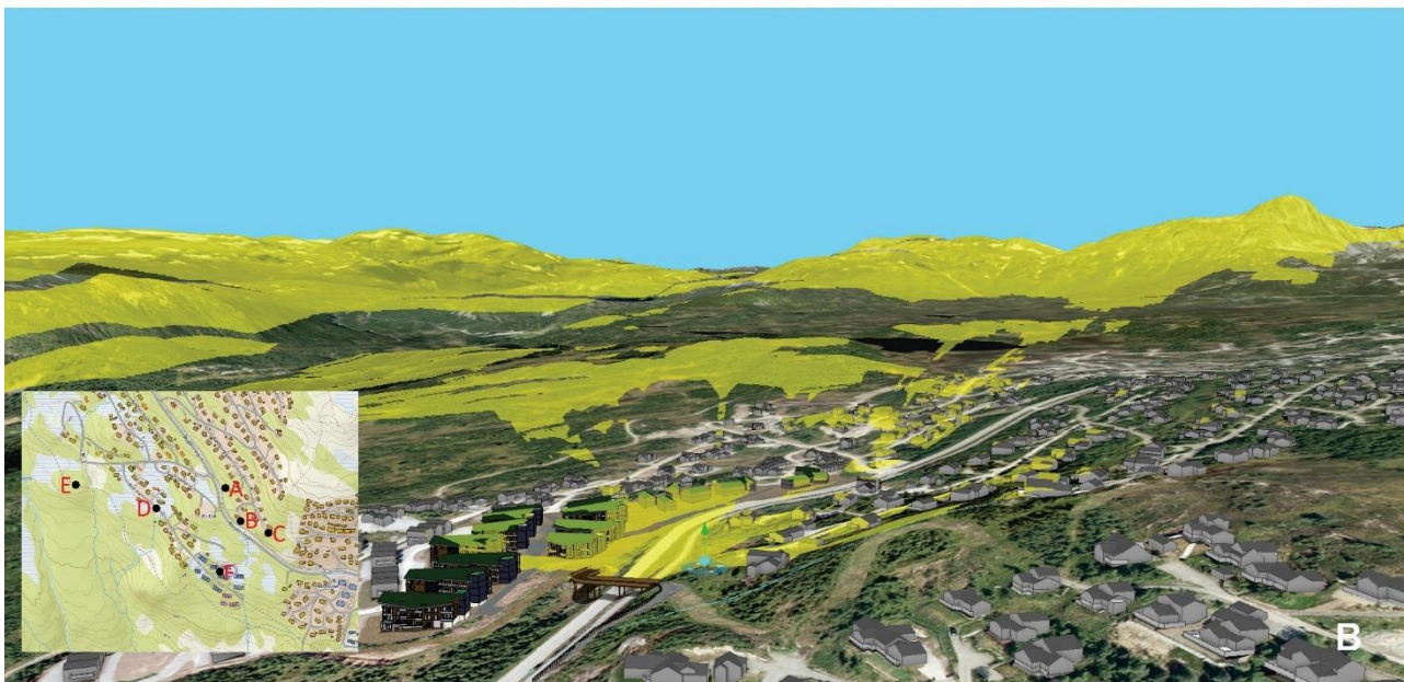
Figur 4.6: Utsnitt frå 3D-modellen som syner synlegheit frå standpunkt C sett mot sørvest (bilde oppe merka A) og nordvest (bilde nede merka B). Augehøgde på markøren er 1,5 meter. Gul skravur viser synlege område (Kjelde: Feste AS).
