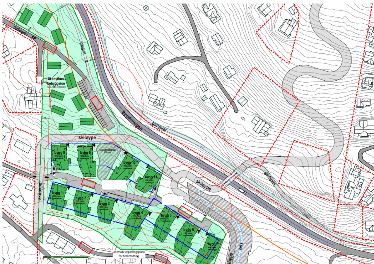
Figur 3.11: Illustrasjonen syner inngangar, tilkomst til parkeringsanlegga, areal for varelevering og renovasjon, samt oppstillingsplassar for brannredning (raud firkant).
