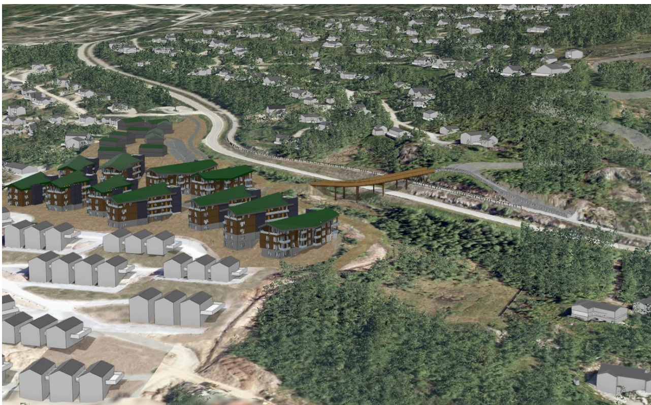
Figur 3.10: Illustrasjonen syner planlagt kryssing av Bygdinvegen (Fv. 51) med ny kombinert ski- og gangbru, med tilhørande samband mot gang-/sykkelvegen nord for Bygdinvegen (Kjelde: Feste AS).
