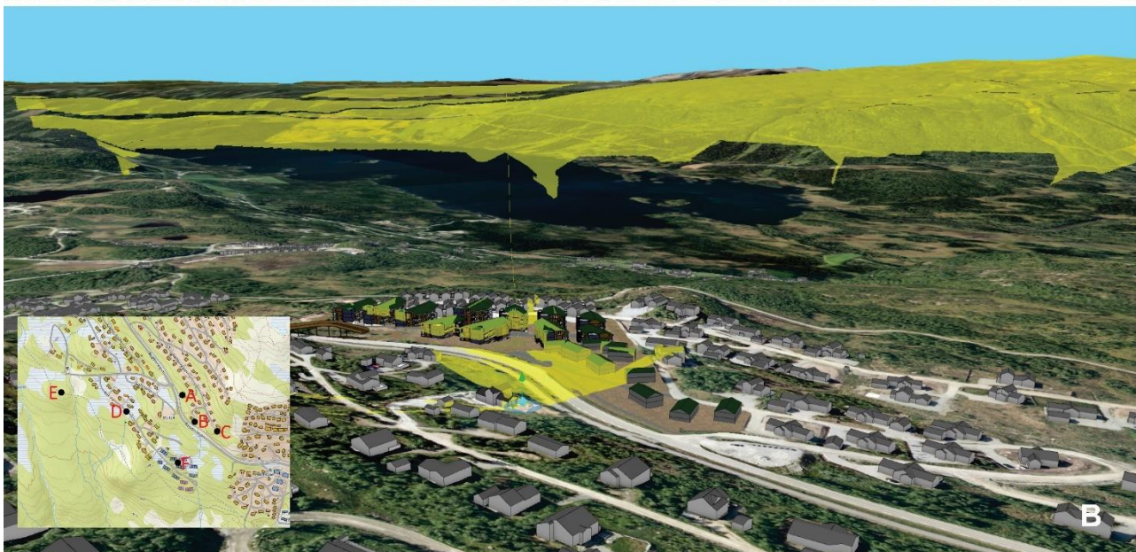
Figur 4.5: Utsnitt fra 3D-modellen som viser synlighet fra standpunkt A sett mot sørvest (bilde oppe merka A) og nordvest (bilde nede merka B). Augehøgd på markøren er 1,5 meter. Gul skravur viser synlege område (Kjelde: Feste AS).
