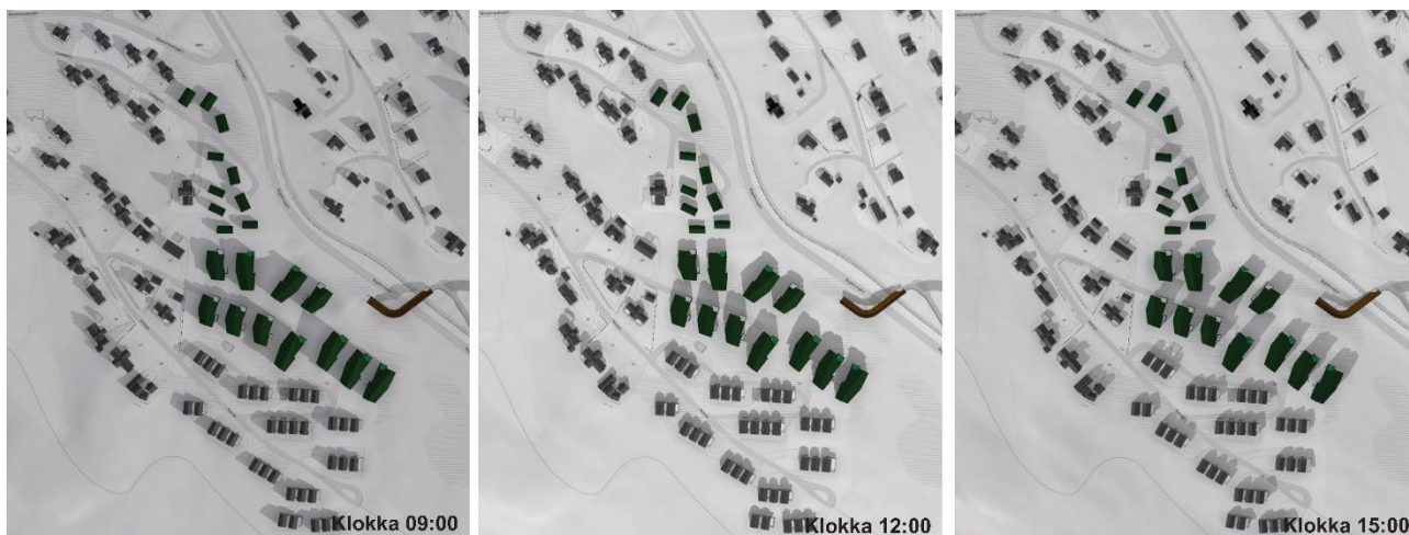
Figur 4.9: Sol-/skuggeanalyse for 22. september klokka 09:00, 12:00 og 15:00. Mørkegråfarge syner frå eksisterande og planlagde bygg (Kjelde: Feste AS).
