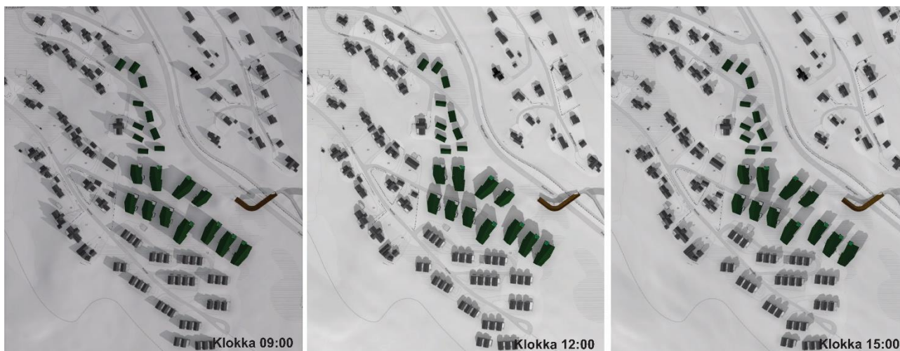
Figur 4.7: Sol-/skuggeanalyse for 21. mars klokka 09:00, 12:00 og 15:00. Mørkegråfarge syner frå eksisterande og planlagde bygg (Kjelde: Feste AS).
