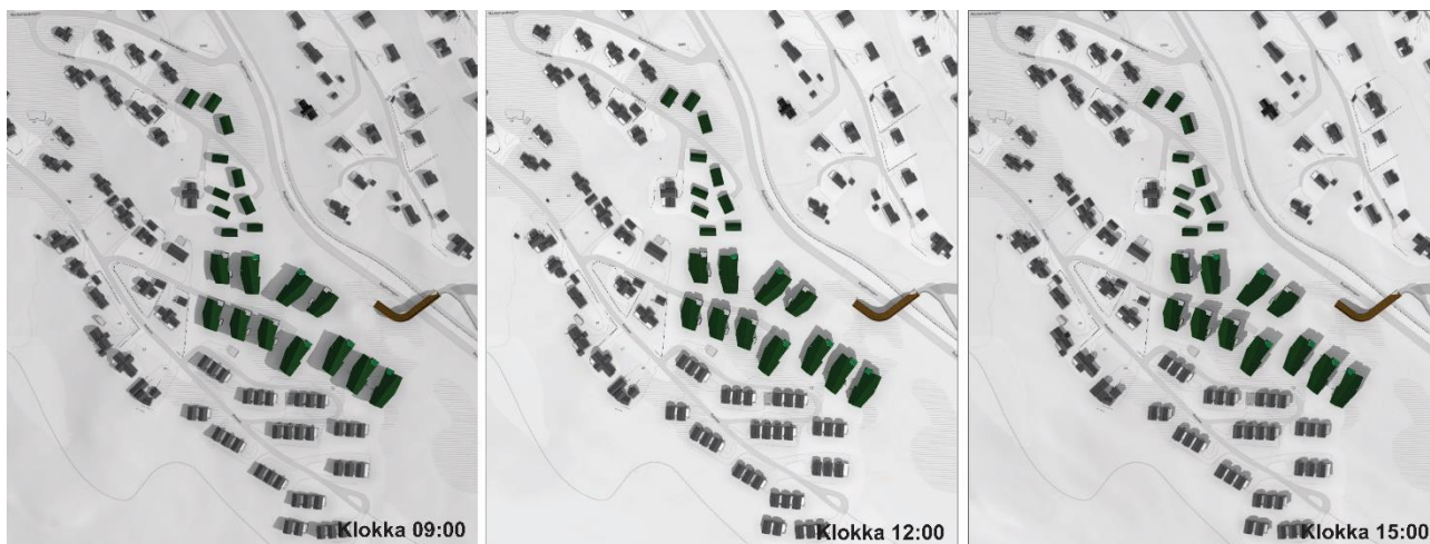
Figur 4.8: Sol-/skuggeanalyse for 21. juni klokka 09:00, 12:00 og 15:00. Mørkegråfarge syner frå eksisterande og planlagde bygg (Kjelde: Feste AS).
