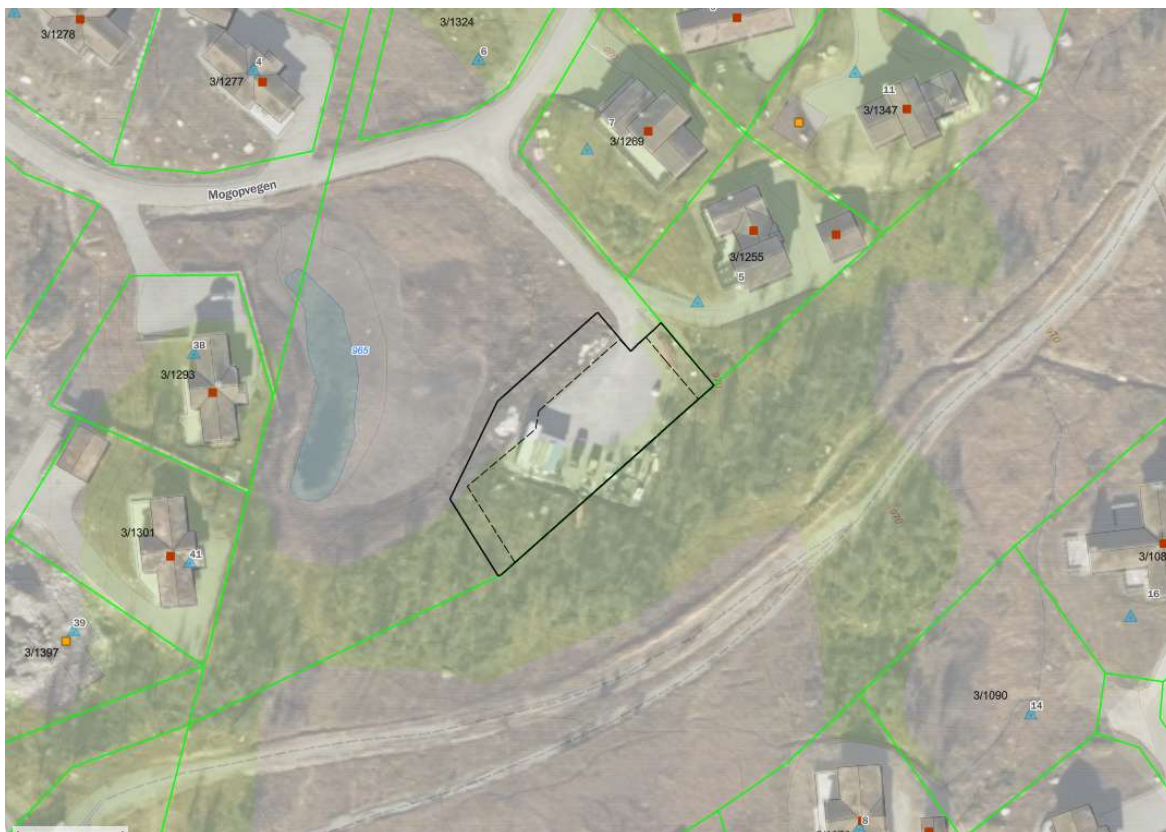
Byggegrensen er trukket langs gruset areal og tomtgrense følger fyllingsfot mot myrareal.
